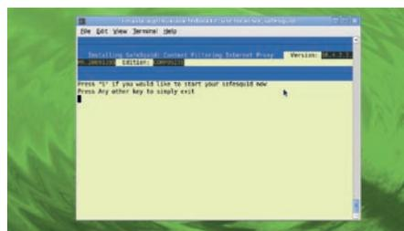
**5 Завершение установки** > Тщательно следуйте инструкциям на экране, потому что периодически будут спрашивать вашего согласия. Можно запустить *SafeSquid* сразу же или сделать это позже, по команде **/etc/init.d/safesquid start**.
