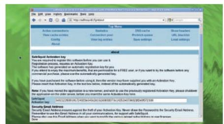
**6 Активация SafeSquid** > Наконец, настройте в своем браузере IP-адрес и порт, заданные при установке, в качестве прокси-сервера. Затем, открыв <http://safesquid.cfg>, выберите About и введите адрес электронной почты, выданный на форуме.
