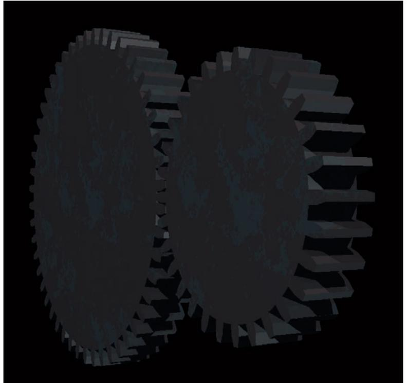
в последнем кадре; далее следует имя файла сцены (расширение **\*.pov**) или файла с настройками (**\*.ini**). Выполнив **povray +KFF15 +KF3 mech.ini**, получим 15 кадров анимации поворота шестерёнок на 3 зубца. На выходе будет набор из 15 файлов с кадрами: воспользуйтесь сторонней графической программой (**GIMP**, **ImageMagick**, **Blender** и т.д.) и соберите их в анимированный GIF, PNG или видеофайл. **LXF**
